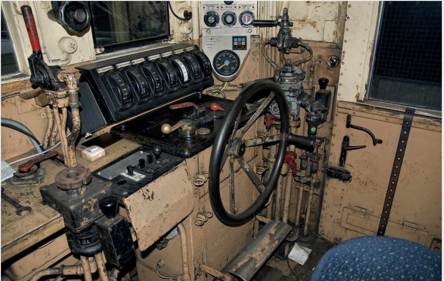
Erwin Mosshammer wirft einen Blick in den Führerstand der 194 158. Selbst in den knapp 50 Jahren Dienstzeit blieben die Führerstände der Baureihe 194 nahezu unverändert. Mit dem roten Hebel oberhalb des Handrads wird der Umschalter für die E-Bremse betätigt (10 Bremsstufen).
