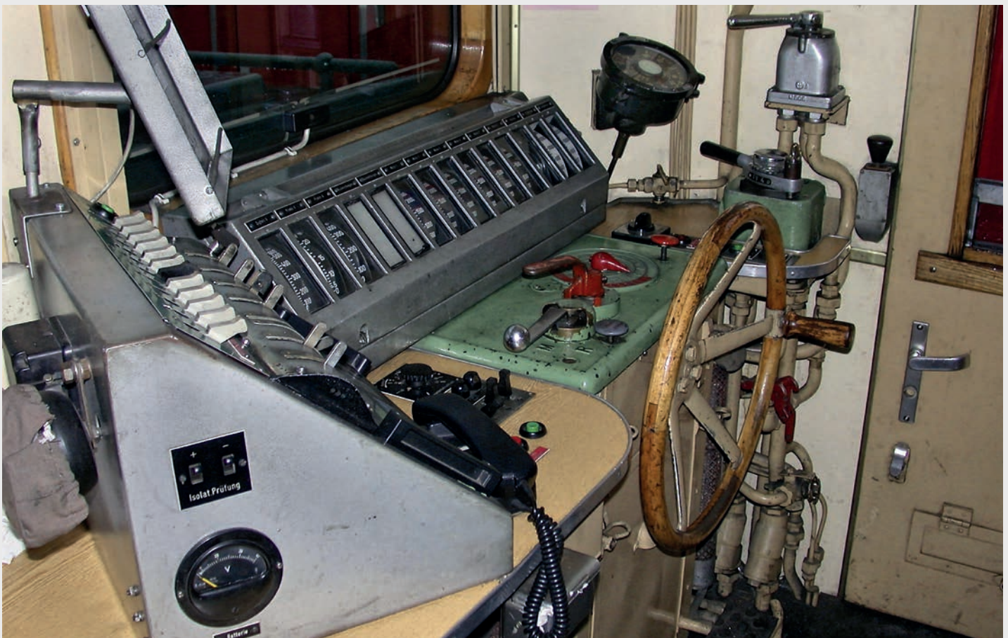
Arbeitsplatz 1020 042: Unter dem Fenster befinden sich die Messgeräte, davor der Fahrschalter mit dem Handrad, rechts die Bremsventile, im Vordergrund der Schritten mit den Geräten zur Inbetriebnahme sowie die Zugfunkanlage (Foto: Erwin Mosshammer).
