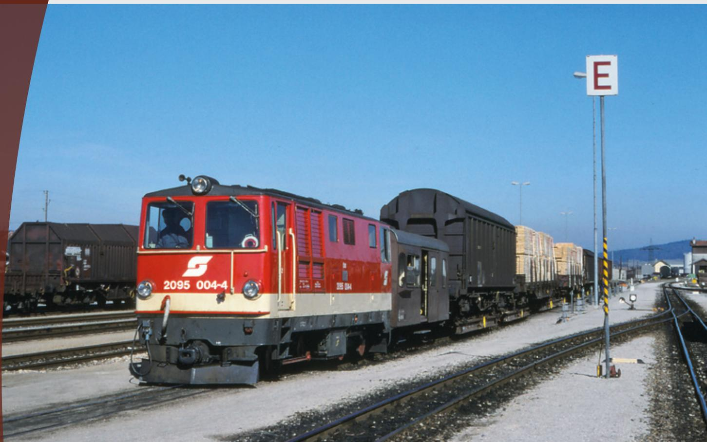
Die 2095.004 verschiebt am 20. Februar 1990 in Wieselburg a.d. Erlauf. Eine Reihe von beladenen Rollwagen werden auf die Aufrollanlage geschoben, die dann von dort in den Bereich der Normalspur übernommen werden können. Foto: Harald Dörner
