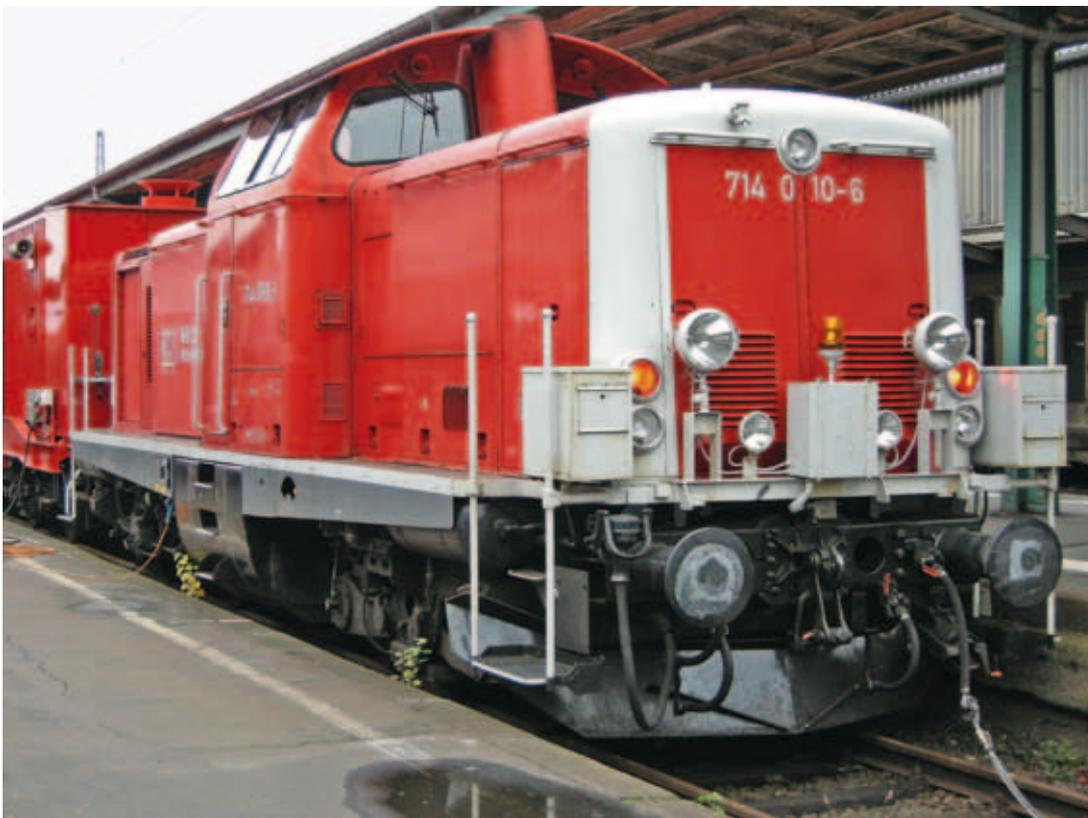
Für die ICE-Strecken unterhält DB Netz Notfalltechnik mehrere solcher Rettungszüge für den Einsatz in den oft sehr langen Tunnels.
