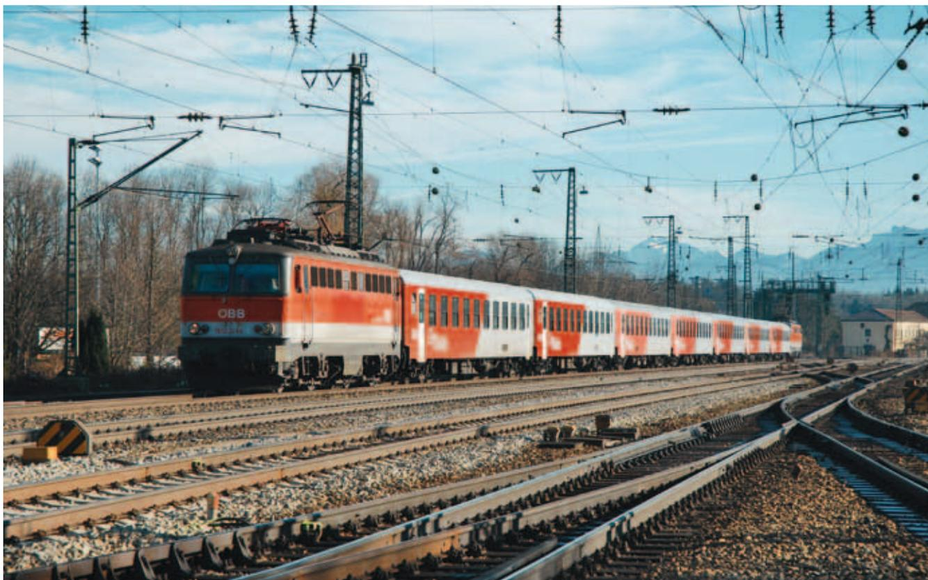
Die ÖBB stellte einen Nahverkehrs zug mit Schlierenwagen (City Shuttle) und zwei 1142 Elektrolokomotiven zur Verfügung. JG
