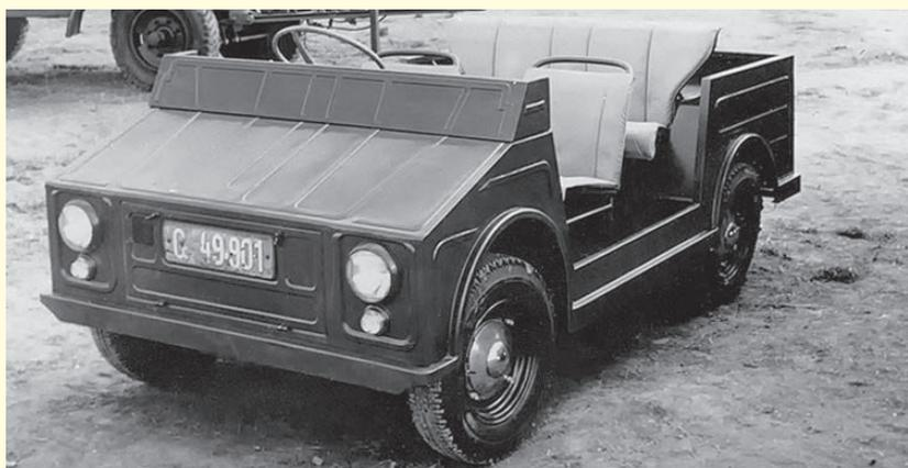
Dabei überlegte Konstrukteur Egon Rudolf unter anderem, eine Plattform auf Zentralrohr mit einem Frontmotor auszustatten. Das ist der Puch 600 M. Rudolf notierte, man habe vom VW Kübelwagen im Afrika-Feldzug gewusst, dass die Staubentwicklung einem Heckmotor im Fahrbetrieb schwer zusetzt. In jenen Tagen wurde viel überlegt, gezeichnet und geschraubt. Kaum etwas davon ließ sich produzieren. (Was den Puch 600 M und 600 AM angeht, finden Sie anschauliche Holzmodelle im Johann Puch Museum Graz.)
