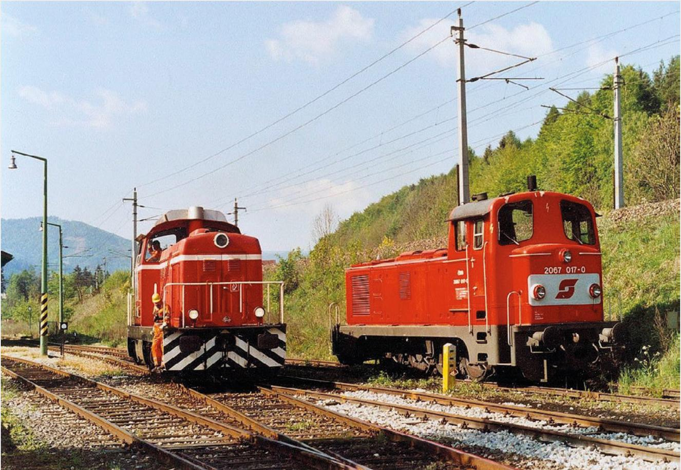
Zwei Werklokomotiven der Anschlussbahn zum Industriebetrieb in Mürzzuschlag. Links die Maschine mit der Achsfolge B'B'-dh, mit 700 PS, gebaut 1981 von „23. August“ in Bukarest. Rechts die Leihlokomotive ÖBB 2067 017-0. Foto: A. Moser
