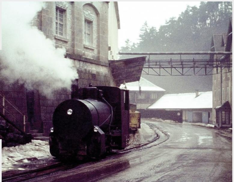
Im Werksbereich Josefstal hält die Speicherlokomotive, um über die Weiche die im Bereich der Spillanlage befindlichen Wagen, zu übernehmen.
