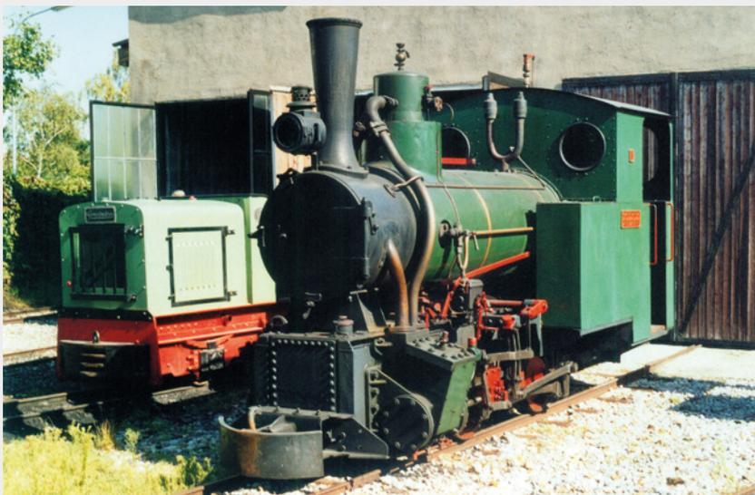
*Auf der heute als Museumsbahn bestehenden Schwarzgranbahn von Cierny Balog nach Hronec ist eine für die Heeresrollbahn mit der Nr. 368 von Smoschewer in Breslau gebaute Dampflokomotive der Type RIIIc nach einer Umspürung von 600 auf 760 mm in Verwendung. Die Lokomotive mit den Baudaten C-n2t, Smoschewer 625/1918 blieb nach ihrer militärischen Verwendung durch den Einsatz bei verschiedenen Baufirmen erhalten und kam 1986 zur Waldbahn Hronec.*
