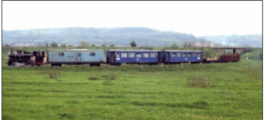
Unterführung unter der CFR-Hauptstrecke bei Moichen im Frühjahr 1994. Zwischen Moichen und Hermannstadt verlaufen Schmalspurstrecke und Hauptstrecke als Dreischienengleis. (Hans Hufnagel)
