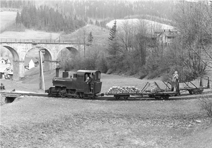
Abb. 5. In unmittelbarer Nähe der Waldbahn-Verladerampe Steinhaus führt die dreiachsige Decauville-Lok am 6. Mai 1958 für die „Abschiedsfahrt“ Rangierarbeiten durch und wird bald einen anderen Waldbahnwaggon auf dem Ausweichgleis dahinter abholen. (Foto: Alfred Luft)
