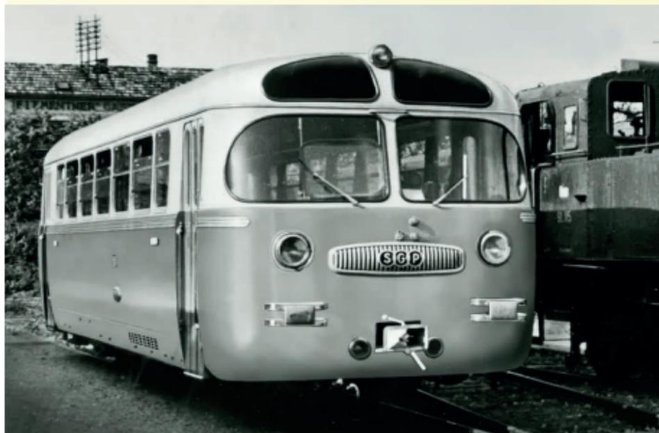
Der SGP VT 20 erwies sich im Gegensatz zum Uerdinger Schienenbus als zu schwach und anfällig. Darum wurde dieses Fahrzeug nie in Serie gebaut.
