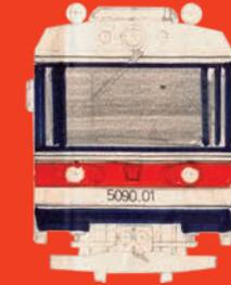
Hier stimmen die Abmessungen schon exakt auf den 1985 bereits in Produktion befindlichen ÖBB-5090. Valousek experimentierte mit unterschiedlichen Farbaufteilungen in rot und blau – klassisch in Längsstreifen mit schräg ausgenommenem „Pflatsch“ oder mit roten Einstiegstüren, einer roten Stirngestaltung und blauem Fensterband. (A.SGB)
