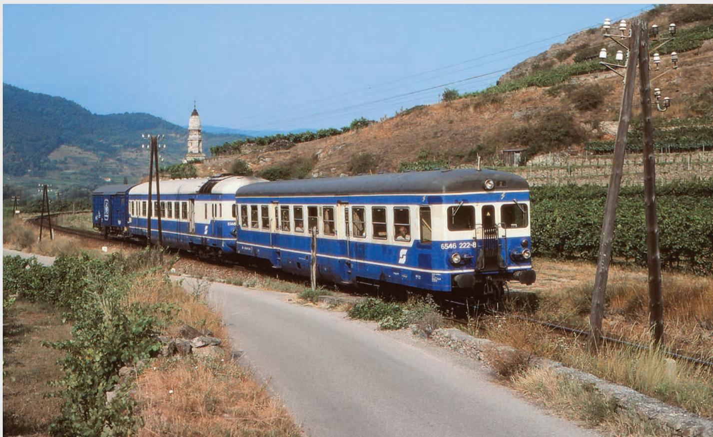
Auf der Fahrt nach Krems hat am 28. August 1990 die Triebwagengarnitur 6546 222 + 5146 202 des R 6113 gerade das Franzosendenkmal am Fuße des Höherecks bei Oberloiben passiert, das 1905 zum Gedenken an die Schlacht von Loiben errichtet wurde. Durch Umbau von 1958 gebauten Reisezugwagen Bp 20-04 sind von 1979 bis 1986 die Steuerwagen 6546 221-226 mit kantiger Front entstanden. (KH)
