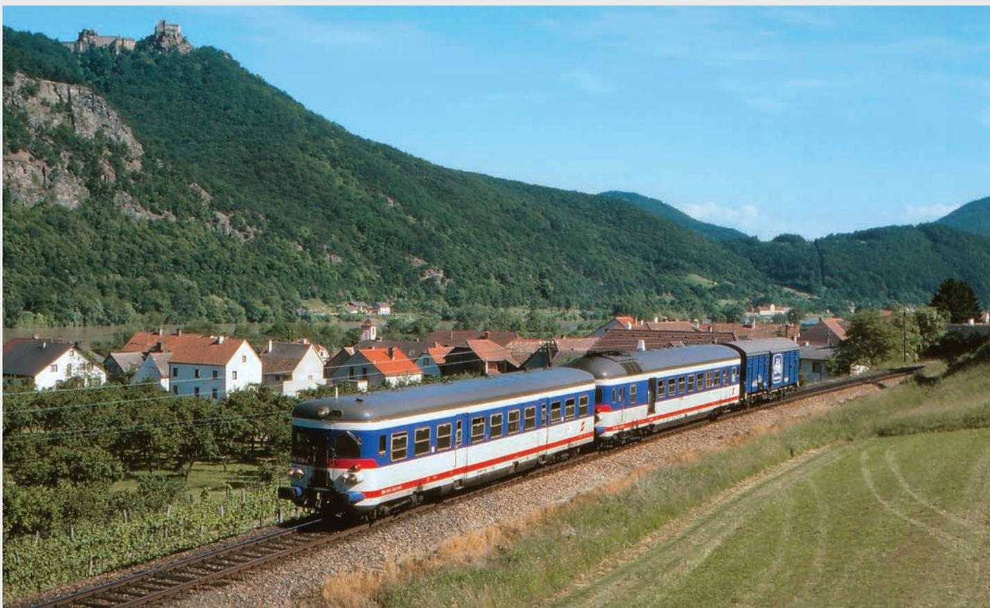
Durch Einbau eines Führerstandes in die 20 Beiwagen der Reihe 7046 sind ab 1965 die 20 Steuerwagen der Reihe 6546 mit gerundeter Front entstanden. Einige Altbaufahrzeuge erhielten wenige Jahre vor ihrem Ausscheiden noch eine den neuen Dieseltriebwagen 5047 und 5147 angepasste Lackierung. In dieser zeigt sich die Triebwagengarnitur 6546 219 + 5146 205 am 22. Juni 1991 als R 6113 bei Willendorf. (KH)
