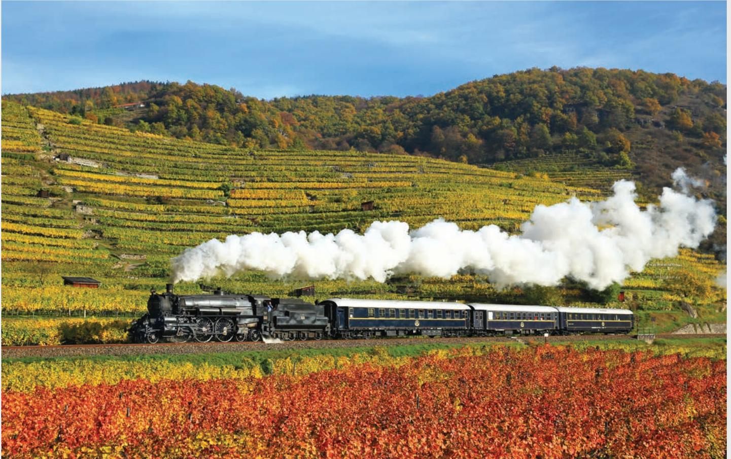
Wenige Kilometer weiter rollt der Sonderzug bei Weißenkirchen durch die herbstlich verfärbte Wachau. Die 100 km/h schnelle Maschine beeindruckt vor allem mit ihren imposanten Treibrädern, die einen Durchmesser von 2,14 Metern aufweisen. Eingesetzt wurde sie von der kkStB unter anderem auf der Franz-Josefs-Bahn. (RB)
