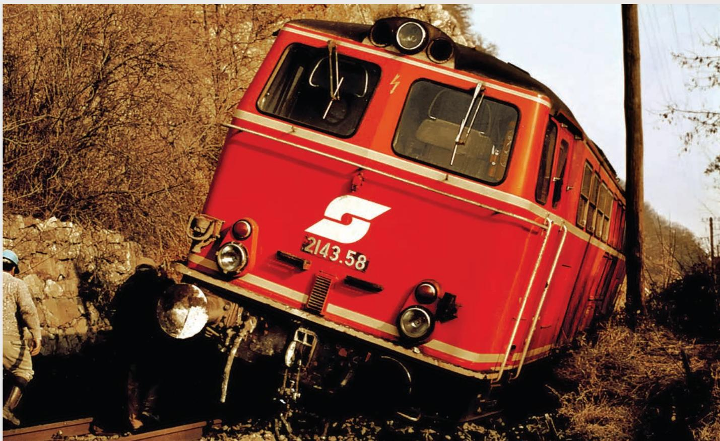
In den Morgenstunden des 5. Dezember 1979 prallt die 2143.58 des von Krems kommenden P 6110 in km 50,722 zwischen den Bahnhöfen Marbach-Maria Taferl und Persenbeug in etwa 40 bis 50 m<sup>3</sup> auf die Gleise gestürzte Steine. Wegen dichten Nebels kommt die Notbremsung des Triebfahrzeugführers zu spät, es gibt aber keine Verletzten. Der Sachschaden an Lok, Wagen und Oberbau beträgt rund 282.000 Schilling. (SGB)
