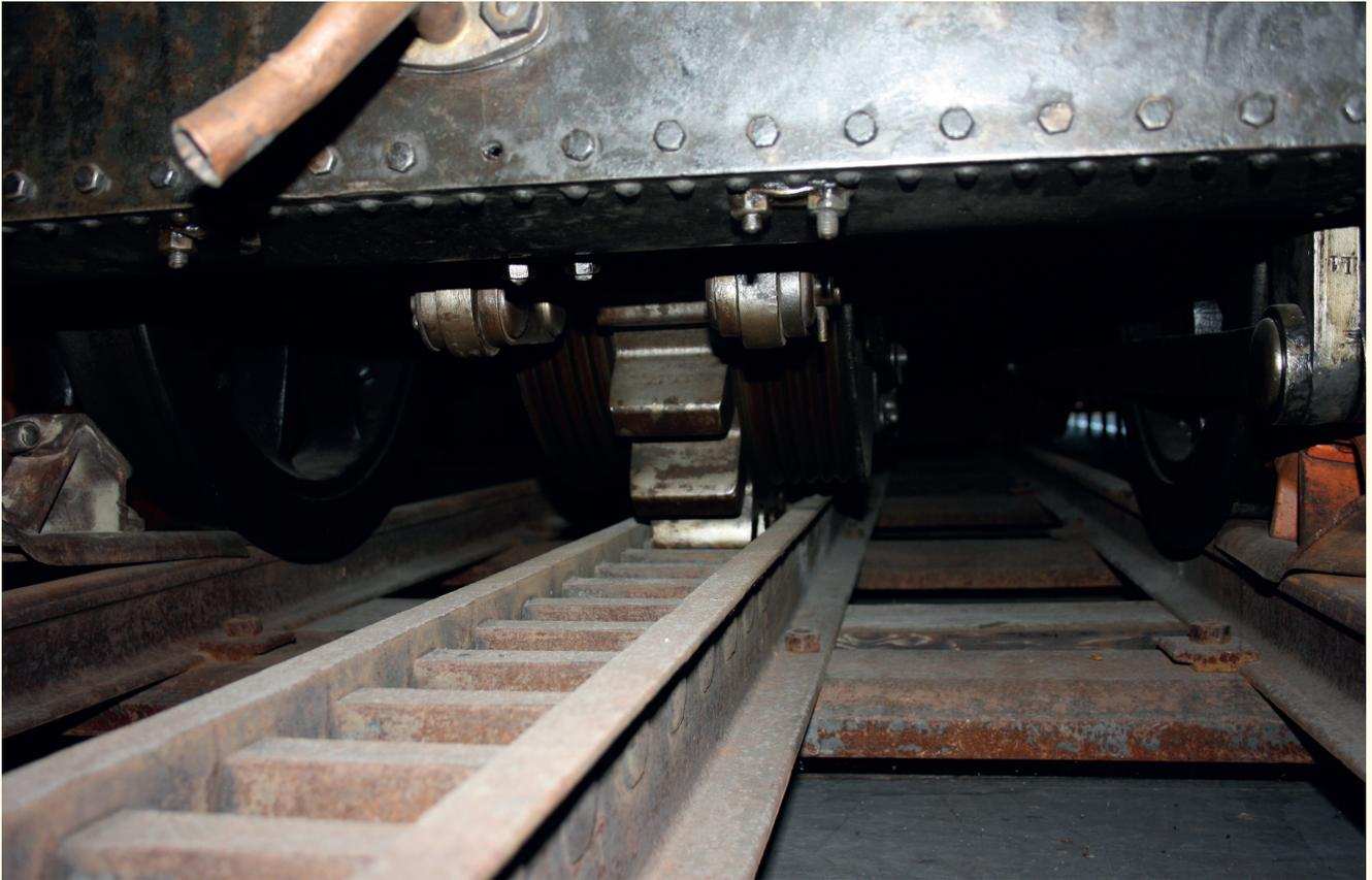
Die vorne befindliche Zahnradbremse mit beiderseits des Bremszahnrades angeordneten Rillenscheiben.
