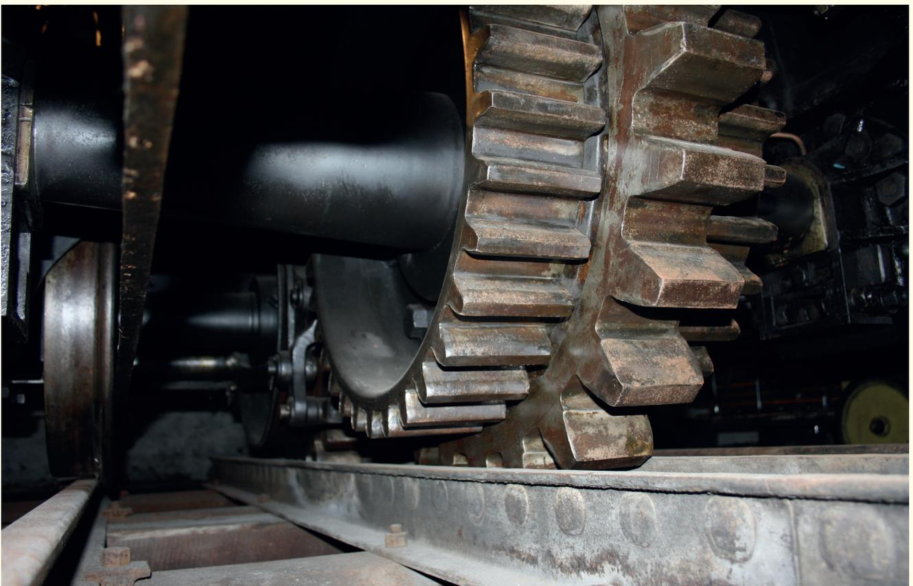
Das in die Riggenbach-Zahnstange eingreifende Triebzahnrad mit den beiden Zahnrädern der Kraftübertragung.
