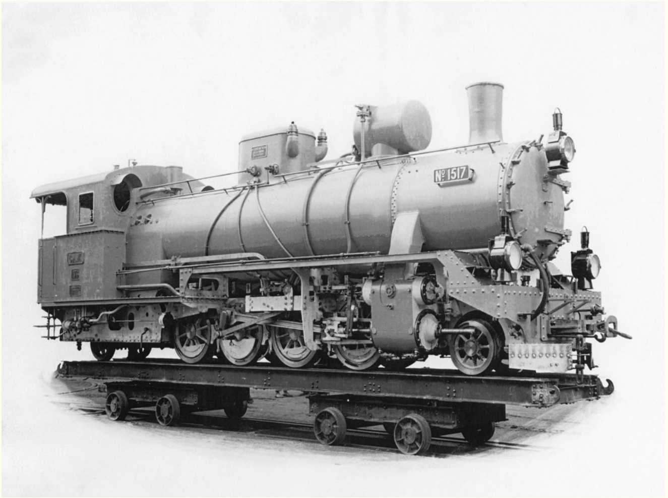
SDŽ IVc 6 Nr. 1517, JDŽ 85-017 (Budapest 5047/1930) als 1D1-Heißdampfvariante, geliefert für die Serbische Staatsbahn. Slg. Lothar Rihosek
