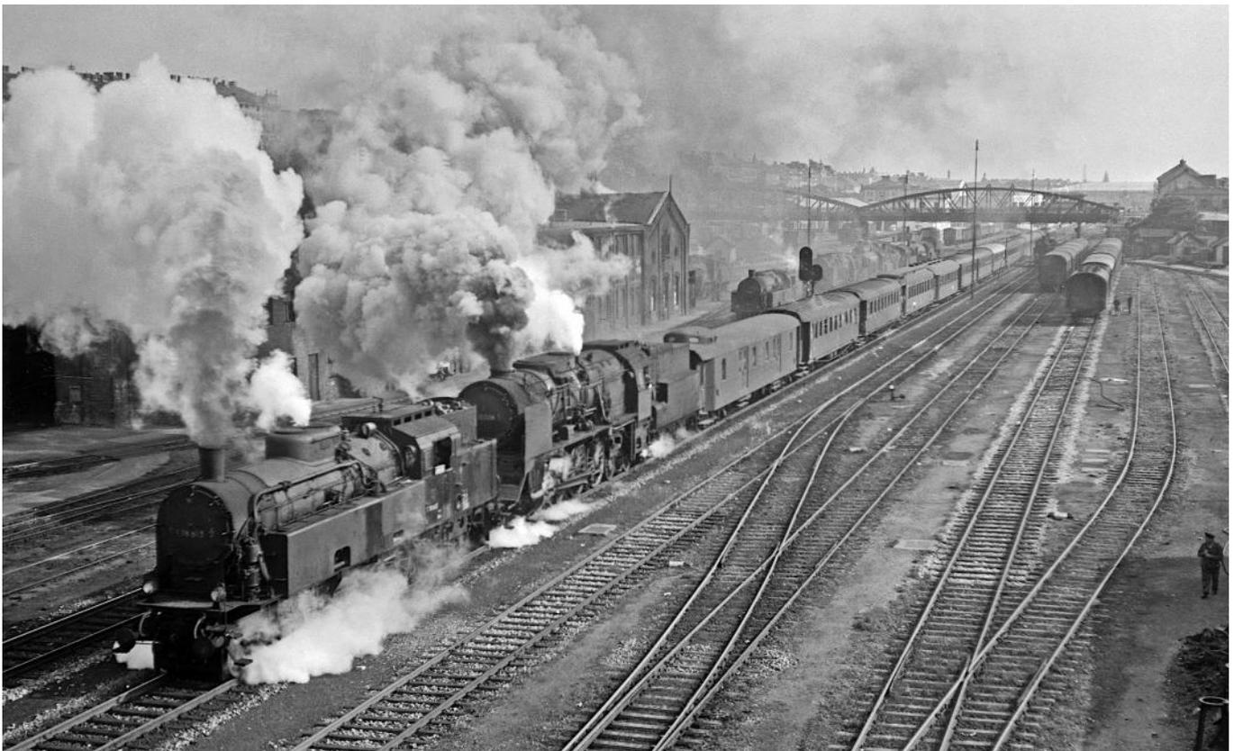
Für diesen langen 14-Wagen-Zug benötigte die 12 006 die Hilfe einer Vorspannlokomotive. In diesem Fall war es die 78 613 – eine Bespannung, die zu BBÖ-Zeiten aus Belastungsgründen noch unzulässig war. Die Aufnahme entstand vom Rustensteg in Blickrichtung Westbahnhof, sodass neben dem Zug auch das Heizhaus und die Tragwerke der ersten Schweglerbrücke zu sehen sind. (Franz Kraus/Archiv Josef Pospichal)
