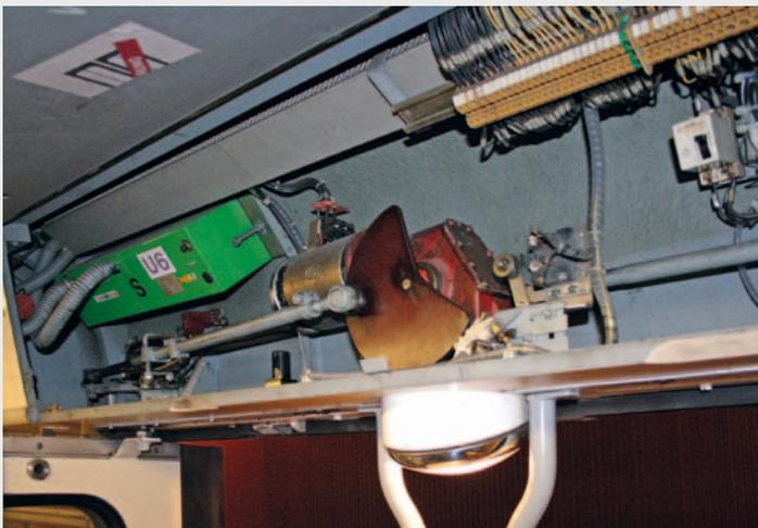
Türantrieb mit Motor und Schubstangen. Die Türsteuerung ist im grünen Kasten eingebaut.
