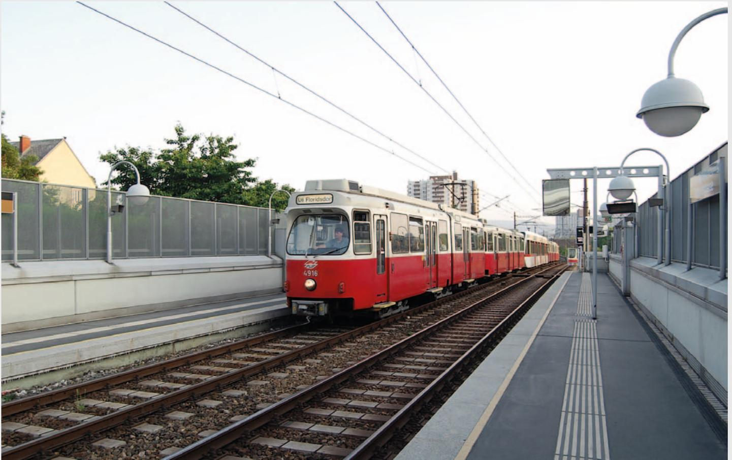
Michael Sturm konnte am 27. Mai 2008 den E<sub>6</sub> 4916 mit einer E<sub>6</sub> + c<sub>6</sub> + T + c<sub>6</sub> + E<sub>6</sub>-Garnitur bei der Einfahrt in die Station Tscherttegasse fotografieren. Bei dieser Station ist nur die halbe Bahnsteiglänge überdacht worden und man kann den an einem Ausleger montierten Abfertigungsspiegel für die Abfertigung von Kurzzügen gut erkennen.
