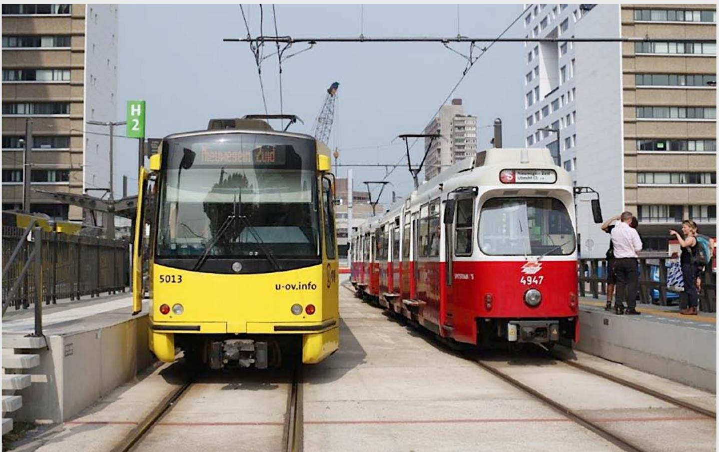
Ein aus zwei E<sub>6</sub> gebildeter Zug der Linie 260 mit dem Triebwagen 4947 an der Spitze steht in der Endstelle Utrecht Centraal neben dem im neuen gelben Farbschema lackierten Triebwagen 5013, der bei der Schweizerischen Industrie Gesellschaft Neuhausen (SIG) gebaut wurde. Foto: Bas Schenk.
