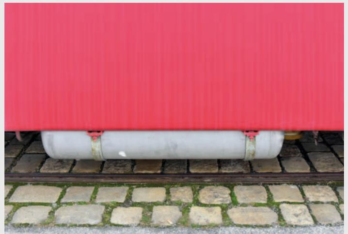
Am Unterboden des Triebwagens wurde im Bereich der verblechten Türe ein großer Druckbehälter für den Kompressor eingebaut. Foto: Michael Sturm, 8. November 2019.
