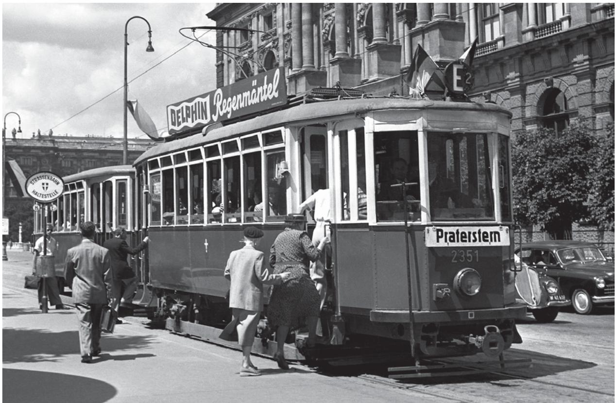
Auf einer Fahrt zum Praterstern hält der 1913 bei der Simmeringer Waggonfabrik gebaute K 2351 + k<sub>3</sub> in der Haltestelle Mariahilfer Straße. Der Triebwagen hat bei seiner Kastenreparatur seine gewölbte Seitenwand behalten. Auch ist der Einbau der Magnetschienenbremse und der ELIN-Dosen noch nicht erfolgt. Hinter dem Triebwagen erkennt man das Kunsthistorische Museum. Foto: Archiv Wiener Linien.
