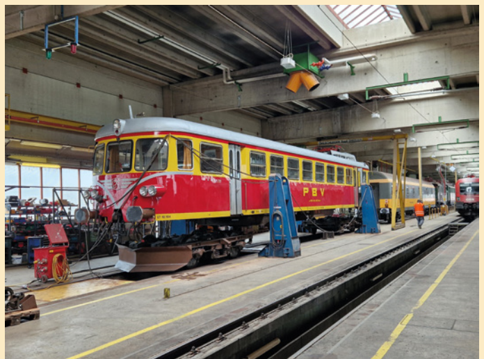
Im Juli 2023 erfolgte eine umfassende Bremsrevision, dazu musste der Wagenkasten in die Höhe.
