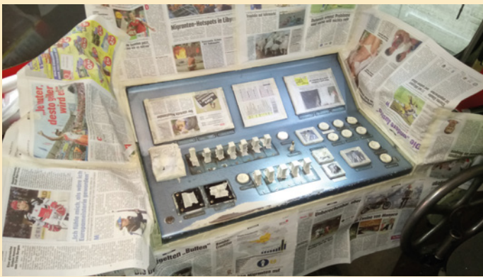
Die beiden Bilder zeigten wieder einen Vergleich; diesmal die Fahrpulte vor und nach der Neulackierung.
